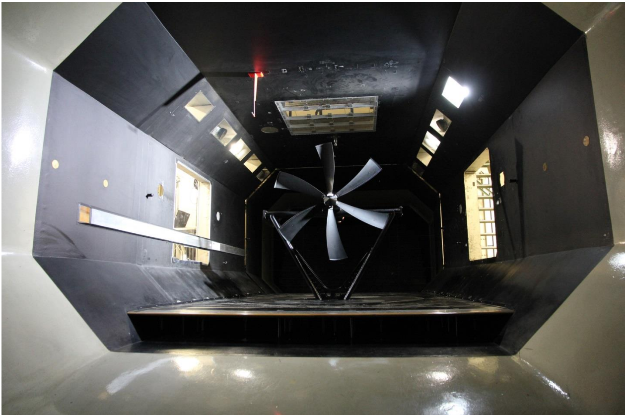
Foto: Ein Modell des Windrads Hans im ETHZ Windkanal
