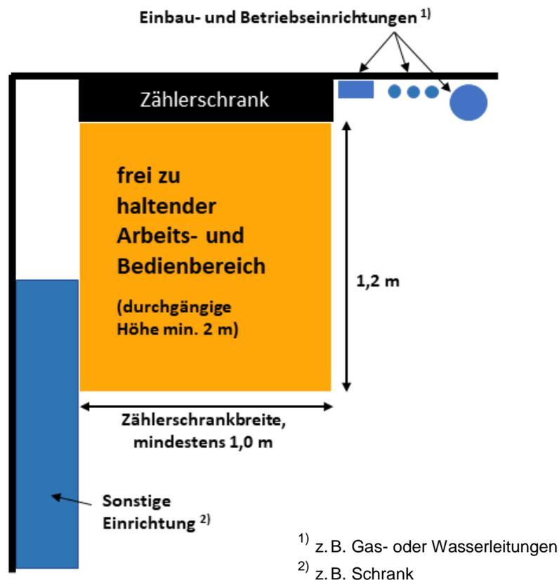
Abbildung 3: Arbeits- und Bedienbereich vor dem Zählerschrank
